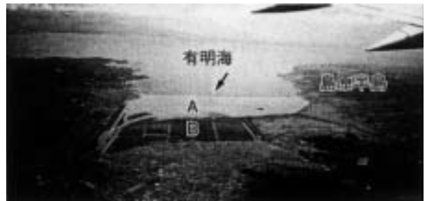
図3 諫早湾の大規模干拓事業。長崎県の諫早湾の奥郡上空から対岸の熊本県荒尾市、福岡県大牟田市の方向を見たところ。全長約7 kmの潮受け堤防(矢印)による潮止めから3年3ヵ月が経過した2000年7月に撮影。A: 淡水化し富栄養化が進行している調整池、B: 干上がったかつての干潟。
